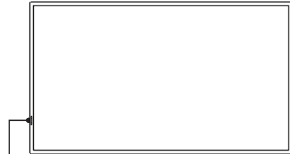
LEDインジケータ リモコン受光部/明るさセンサー
